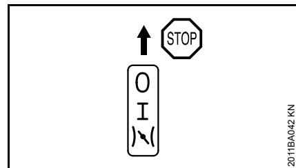
**STOP-0** – двигатель остановлен – зажигание выключено
