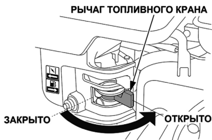
Рис. 8 Топливный кран открыт
