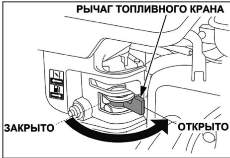
Рис. 8 Топливный кран открыт
