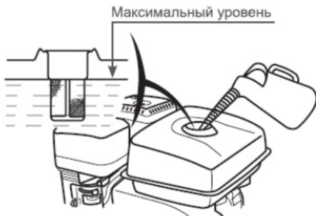
Рис. 7 Максимальный уровень топлива в топливном баке
