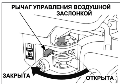
Рис. 10 Воздушная заслонка закрыта
